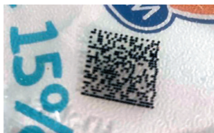
Изображение 2. Каплетруйная печать на линии производителя, наносимая на прозрачную крышку упаковки сметаны
