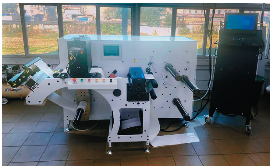
Изображение 5. Пример установленной системы поточной валидации с функцией верификации на устройстве перемотки. Позволяет валидировать до 16 ручьёв стикеров на скорости до 150 м/мин
