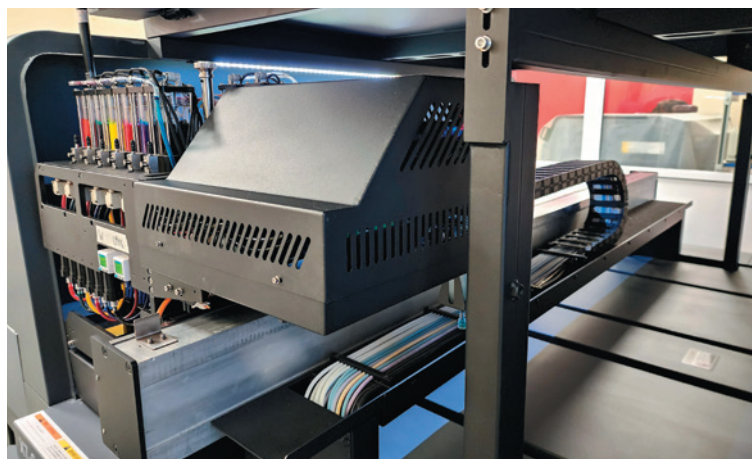
Каретка принтера оснащена пятью печатающими головками Fujifilm (Dimatix) Starfire SG1024
