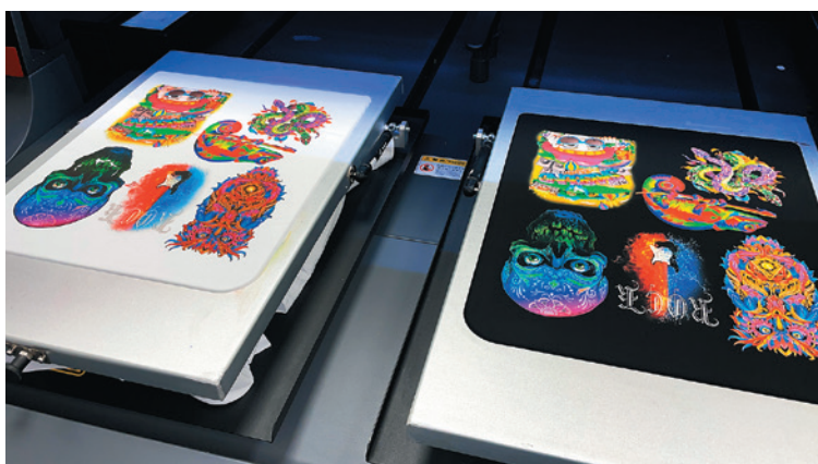
Colors GR-X7 снабжён двумя независимыми рабочими столами с рамками с гидравлическим подъёмом
