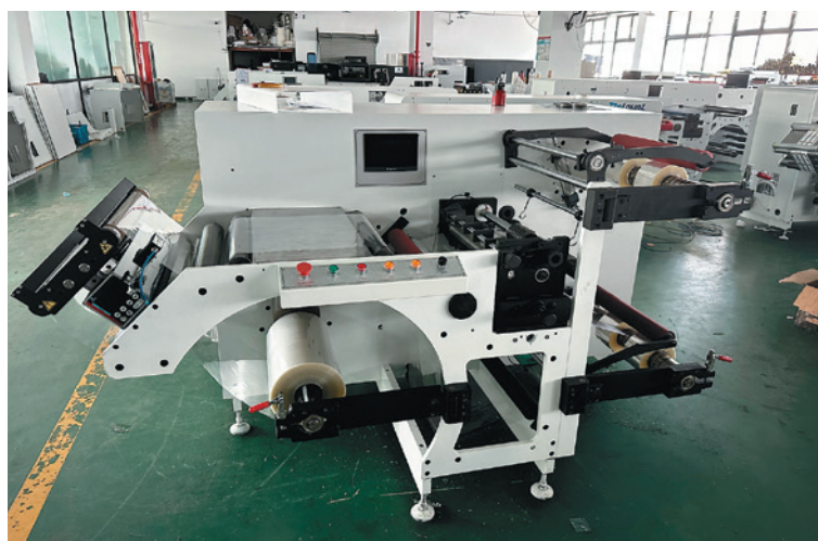
В продвинутой версии бобинорезка SMG Tech 370 COMPACT способна работать с тонкими плёнками
