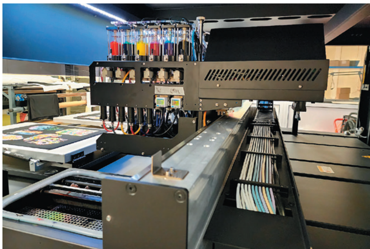
Усиленная направляющая обеспечивает плавное и точное движение каретки
