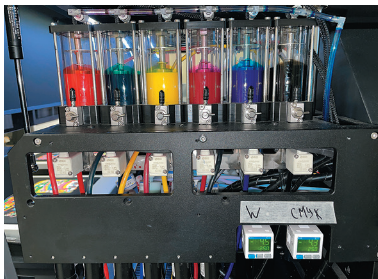
Температура в трактах белых и цветных чернил регулируется по отдельности
