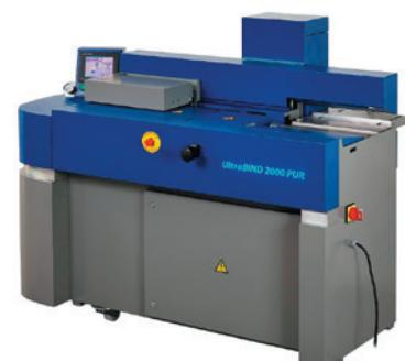
Компактная машина клеевого бесшвейного скрепления с закрытой клеевой системой для ПУР-клей.
