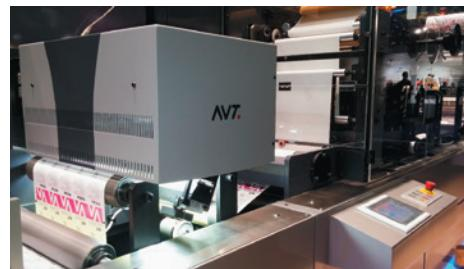
Система автоматической инспекции AVT Helios на сервоприводной перемоточной машине Lesko HI440. 100-процентное выявление различных дефектов печати на максимальной скорости перемотчика без участия человека. Опции для инспекции самоклеящихся, прозрачных и отражающих материалов. Инновационная конструкция с ультрасовременной сканирующей камерой и передовой LED-подсветкой.
