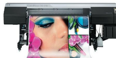
Экосольвентный принтер. Фотопротографическая печать с разрешением до 900×900 dpi. Макс. ширина материала 1626 мм, ширина печати до 1616 мм. Скорость 3,5–66,5 м<sup>2</sup>/ч. Чернила SX, сертифицированные Greengard и 3M, 6 (CMYK, Lc, Lm) или 7 (CMYK, Lc, Lm, Gy) цветов. Печать на виниле, баннерных материалах, бумаге, бумаге с синей подложкой, бэклите, холсте, техническом текстиле.
