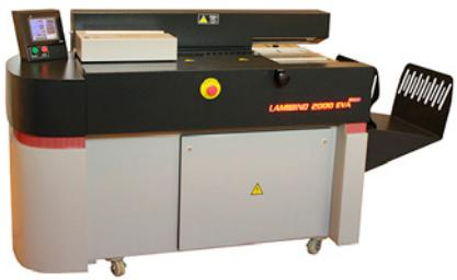
Машина kleевого бесшвейного скрепления с опускаемой фрезой, датчиком наличия обложки и опциональным устройством для приклейки узких полосок (бумага, ткань).
