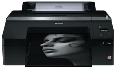
Цветопроба на базе Epson SureColor SC-P5000V. Пигментные чернила Epson UltraChrome HDX, 10 цветов, 11 картриджей. Цветовой охват — до 99% шкалы Pantone, разрешение — 2880×1440 dpi. Печать каплями переменного размера от 3,5 пл. Раздельные картриджи объёмом 200 мл. Автоматическое переключение между стандартным и матовым чёрным. Печать на листах, рулонах и плотной бумаге толщиной до 1,5 мм, формата до А2+. EPSON, зал 14, ст. А126
