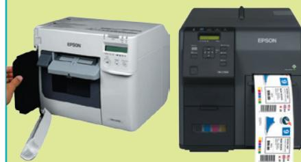
Вниманию посетителей выставки Printech 2018 Epson представляет два принтера серии ColorWorks; модели **Epson ColorWorks C3500** и **ColorWorks C7500G** печатают цветные этикетки со скоростью до 103 и до 300 мм/с соответственно и оснащены встроенными автообрезчиками.
