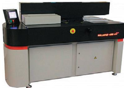
Полуавтоматическая машина kleевого бесшвейного скрепления с ножами продольной насечки на высокоточной дисковой фрезе.
