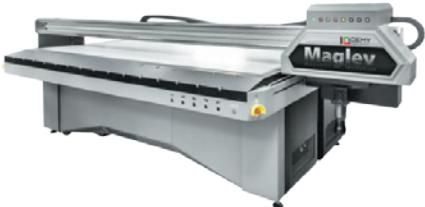
УФ-принтер со светодиодным отверждением с форматом печати до 1200×2800 мм. Технология «магнитной левитации» обеспечивает быстрый и плавный разгон и торможение каретки. Производительность в режиме нормального качества 508×1200 dpi — 24 м<sup>2</sup>/ч, в режиме суперкачества 508×2400 dpi — 14 м<sup>2</sup>/ч. CMYK на одной печатающей головке, минимальный размер капли — до 3,5 пл, рециркуляция белого цвета.
