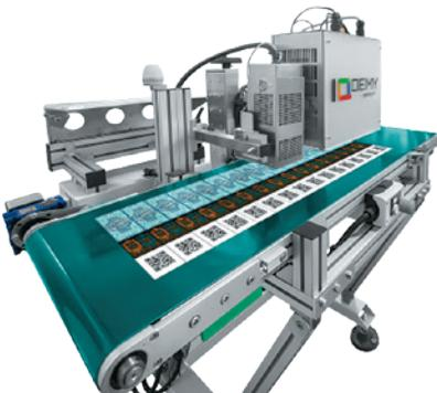
Планшетный (оциально — рулонный) принтер для печати на упаковке со светодиодным отверждением. Движение каретки по горизонтальной и вертикальной осям позволяет наносить маркировку как на верхнюю, так и на боковую сторону изделий. Цветовая схема — CMYK + W, размер капли — 7–21 пл с возможностью уменьшения до 3,5 пл. Разрешение печати — от 360×360 dpi до 1440×1440 dpi. Производительность — до 100 м/мин. Толщина материала — до 200 мм. IQDEMY, пав. 14, ст. C603
