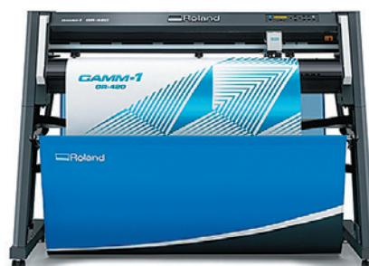
Режущий плоттер с максимальной скоростью резки 1050 мм/с и 1485 мм/с в режиме High speed mode под углом 45°. Давление ножа — 600 г, электронное управление прижимными роликами с 10 уровнями для различных материалов. Роланд ДГ РУС, пав. 14, ст. А211
