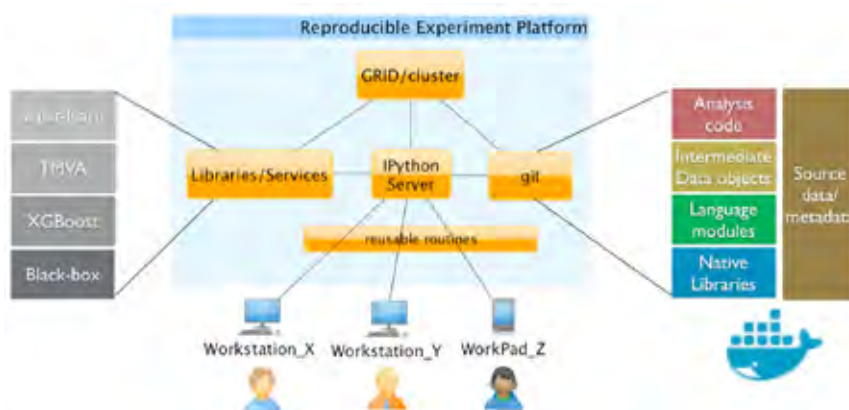
Рис 1. Диаграмма компонентов Reproducible Experiment Platform
